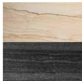
Le Blackwood est une pierre gris-noir plutôt striée et vivante avec des différentes insertions de quartz. C'est une pierre plus lourde que les autres pierres de sable, et sa capacité d'accumulation de chaleur est comparable avec celle de la pierre ollaire. Ces pierres sont disponibles pour Scan-Line Green 200.
